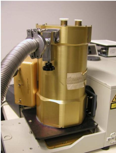
*Figura IV.1c: bolometro a silicio esterno posto in uscita del Bruker IFS 66v/s; in figura si possono vedere il collegamento al sistema di alto vuoto ed i due ingressi presenti sulla parte superiore del dewar per l'inserimento ed il refill degli scudi termici di azoto ed elio.*
